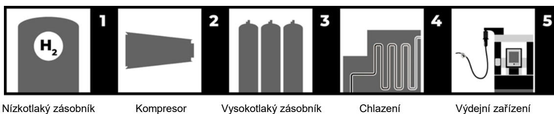
Obr. 1. Schéma vodíkové plnicí stanice
